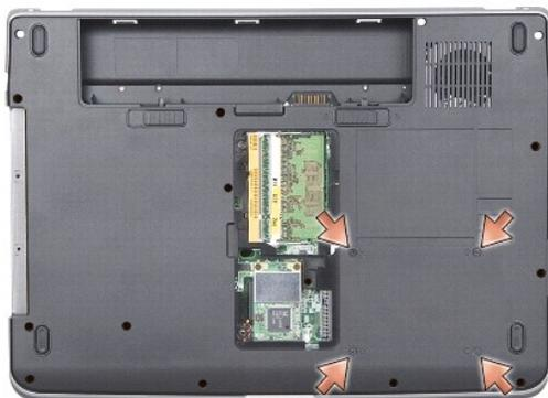
13. Отвинтите два оставшихся винта, которые крепят системную плату к корпусу компьютера.
