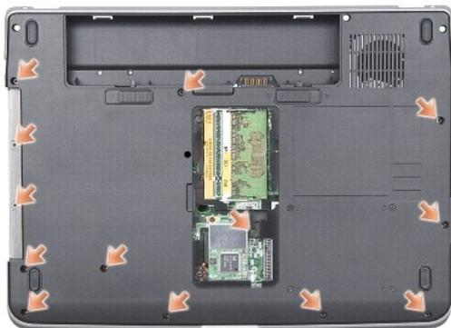
11. Переверните компьютер и выверните два винта из верхней части упора для рук.
